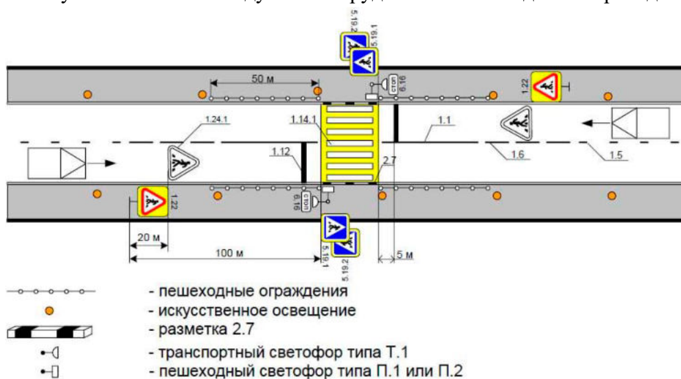
Рисунок 3.5.2. Рекомендуемое оборудование пешеходного перехода
